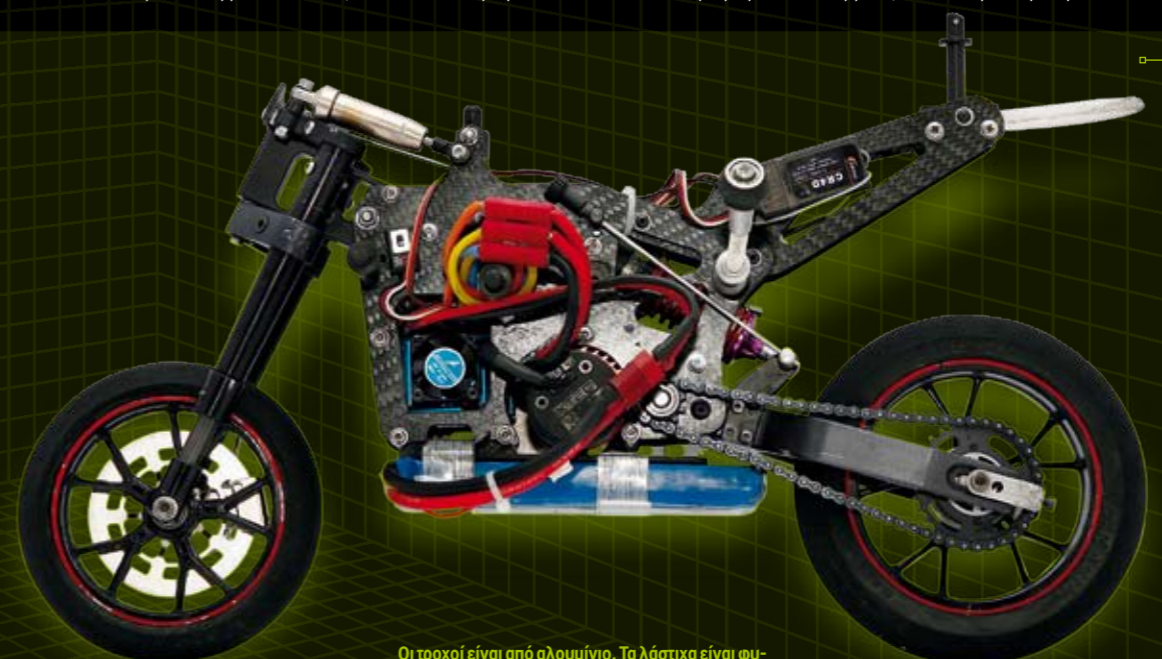
Οι τροχοί είναι από αλουμίνιο. Τα λάστιχα είναι φυσικά λαστικένια και ανάμεσα σε αυτά και τις ζάντες υπάρχει σπογγώδες υλικό που παίζει τον ίδιο ρόλο με τον αέρα των ελαστικών της αληθινής μοτοσυκλέτας μας. Για να μην "μπαλονιάζουν" τα κολλήματα στις ζάντες μεκυσνοακρυλική κόλλα (όπως Ploglo). Η μετάδοση γίνεται με αλυσίδα και γρανάζια. Οι αλουμινένιοι αποστάτες φροντίζουν για την τάση της αλυσίδας. Το ψαλίδι είναι μονοκόμμο, αλουμινένιο και εδράζεται σε μεγάλα ρουλεμάν
