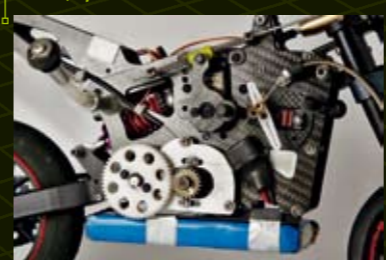
Η πολύπλοκη πλευρά της μοτο: Στο πάνω μέρος διακρίνεται το σύστημα διεύθυνσης, με τα δύο οριζόντια ελατήρια. Στα δεξιά τους ο μηχανισμός που κινεί το μπροστινό φρένο. Το γρανάζι είναι από ανθεκτικό delrin και αλουμίνιο. Στο κάτω μέρος βρίσκεται η μπαταρία, που βάσει των κανονισμών είναι 7,4 βολτ.
