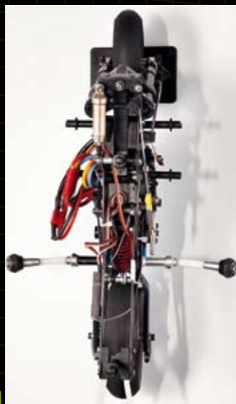
Η κάτοψη δείχνει πολύπλοκη, αλλά δεν είναι. Η σιλουέτα φαίνεται στενή, αλλά σκεφτείτε ότι το KP1 1 είναι 5 χιλιοστά στενότερο. Ο χρυσός κύλινδρος που συνδέεται με την πάνω πλάκα του πιρουνιού είναι το σταμπιλιζατέρ. Τα μαύρα πλαστικά που εξέρχουν από το σασί, είναι τα στρίγματα του φαίρινγκ. Τα αλουμινένια στρίγματα λίγο πιο πίσω, ορίζουν το όριο κλίσης και βοηθούν να ξαναξεκινήσει η μοτο χωρίς εξωτερική βοήθεια σε περίπτωση πτώσης.
