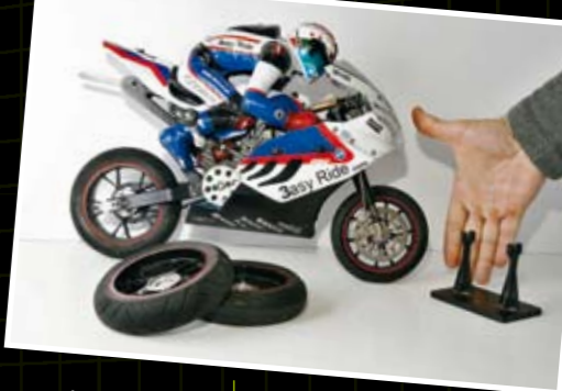
Η κλίμακα είναι 1/5. Ο αναβάτης και το φαίρινγκ είναι φτιαγμένα από διάφανο πολυκαρμπονάτο (lexan) το οποίο βάφεται εσωτερικά, ώστε να μη φεύγει το χρώμα στις αναπόφευκτες-τούμπες. Τα ελαστικά υπάρχουν σε διάφορες γόμες, ενώ θα βρούμε και βρόχινα
