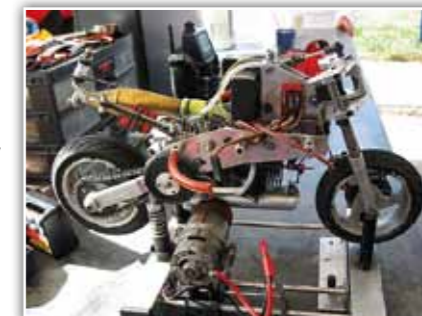
Σύστημα εκκίνησης για nitro, με απλό σπρώξιμο της μοτοσυκλέτας προς τα κάτω
